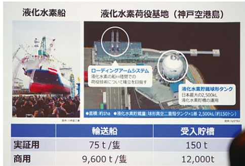
液化水素の運搬船と荷役基地の実証実験
